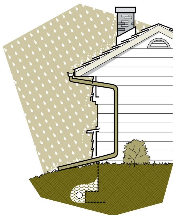
Figure 2-11 L'enveloppe du bâtiment doit permettre à l'eau de s'écouler depuis le toit jusqu'à la semelle
