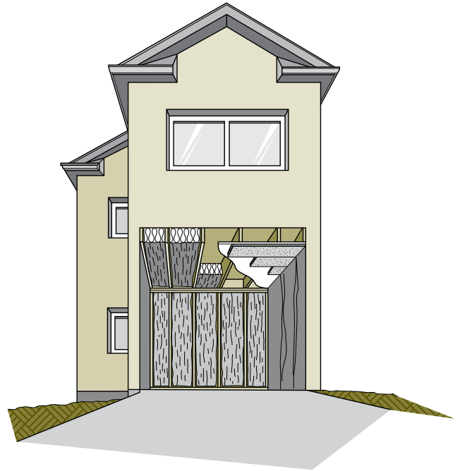
Figure 7-11 Étanchéisation et isolation entre la maison et un garage non chauffé
